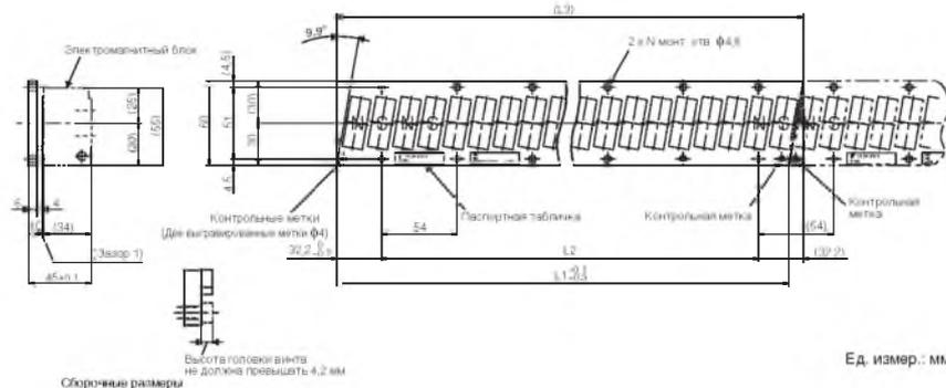
**Примечание: 1.** Возможно последовательное подключение нескольких магнитных путей SGLFM-35□□□□.
