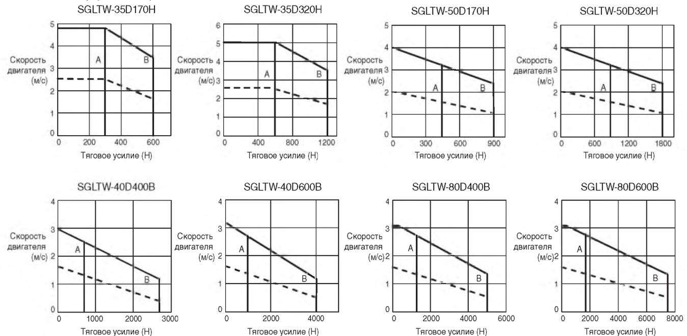
**Примечание:** Пунктирными линиями показаны тяговые характеристики для случая, когда линейный серводвигатель, рассчитанный на 400 В~, запитывается напряжением 200 В~. В этом случае необходимо заменить адаптер последовательного интерфейса. Обращайтесь в службу технической поддержки компании Omron.
