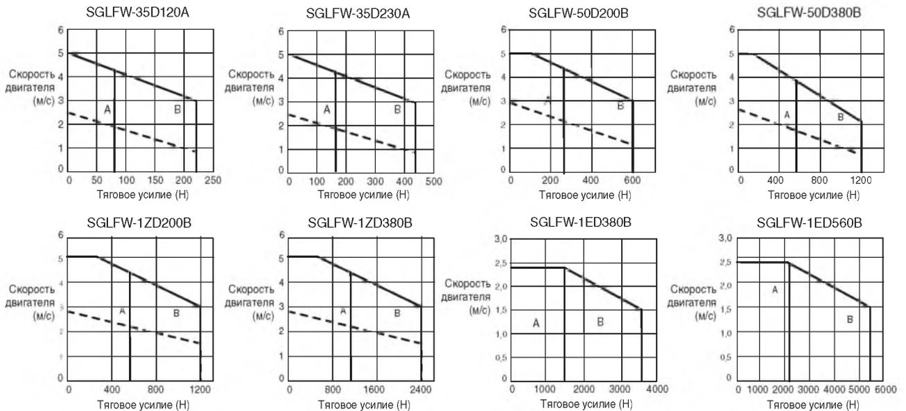
**Примечание:** Пунктирными линиями показаны тяговые характеристики для случая, когда линейный серводвигатель, рассчитанный на 400 В~, запитывается напряжением 200 В~. В этом случае необходимо заменить адаптер последовательного интерфейса. Обращайтесь в службу технической поддержки компании Omron.
