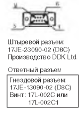
Назначение выводов и параметры разъема датчика Холла
