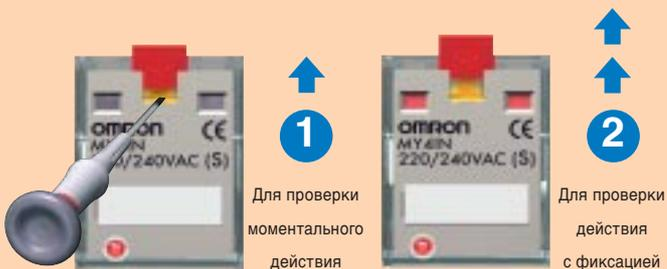
Передвиньте тестовую кнопку в позицию 1, затем нажмите инструментом с изолированной рукояткой желтую кнопку для приведения контакта в действие.
