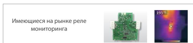
Имеющиеся на рынке реле мониторинга используют емкостный делитель напряжения, который выделяет тепло из-за высокочастотных помех от инвертора, что ведет к сокращению срока службы устройства.
