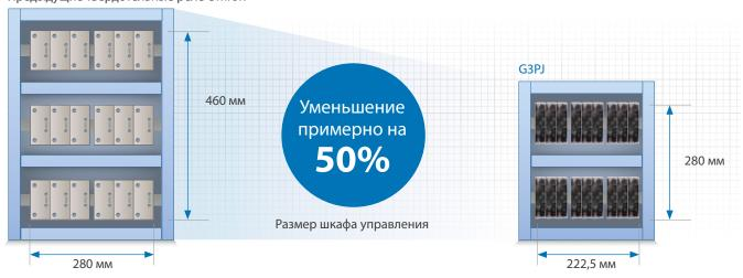
Пример: установка 18 твердотельных реле для трехфазных нагревателей (6 каналов)
